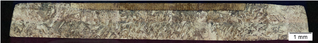
Abbildung 15: Multi-Track-Probe der Legierung Ti-0,44O-0,5Fe-0,08C-0,4Si-0,1Au. Auf der Probenoberseite befindet sich der während der Experimente erneut aufgeschmolzene Probenbereich.
